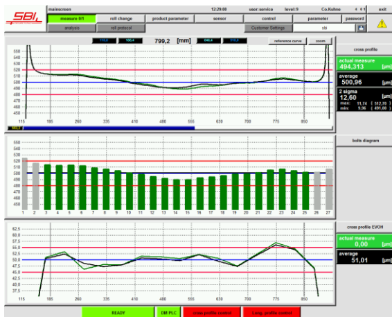
Bildschirm: Gesamtdickenprofil, Bolzendiagramm und Dickendiagramm der Barrierschicht
